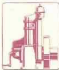
Motores de aceite pesado, verticales, de dos tiempos, sin compresor.
