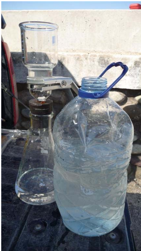
Foto 3: Equipo de filtración
